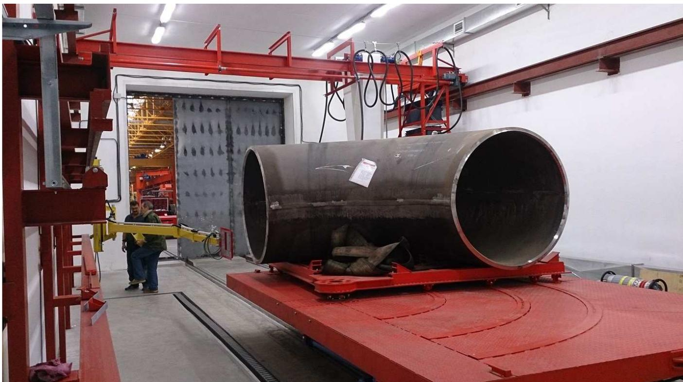
2. Для контроля продольного сварного соединения тройников штанга выстраивается в прямую, параллельную рельсам. Контроль шва производится благодаря движению тележки при неподвижных детекторе и источнике рентгеновского излучения. При необходимости проведения контроля второго продольного шва, геометрия штанги изменяется и детектор разворачивается таким образом, чтобы он оказался вблизи сварного шва изделия.
