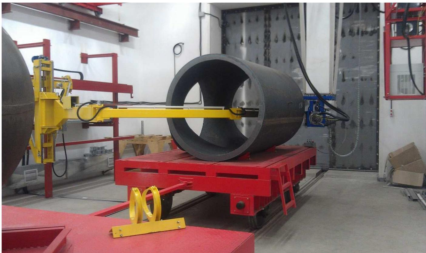
3. Для контроля кольцевых сварных соединений (шов приварки ответвления тройника) штанга выстраивается таким образом, чтоб детектор оказался введённым сверху в отверстие узла трубопровода. Контроль шва производится благодаря движению поворотного стола с объектом контроля на 360° при неподвижных детекторе и источнике рентгеновского излучения.
