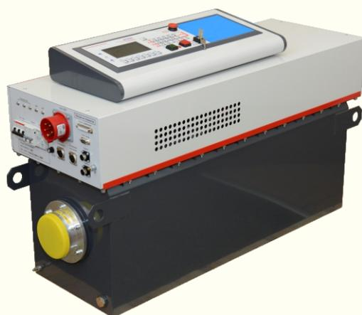
**ЭКСТРАВОЛЬТ МФ** – это серия стационарных кабельных аппаратов с микрофокусными рентгеновскими трубками открытого типа. Размер фокусного пятна от 0,5 микрон позволяет исследовать изделия с крайне высоким разрешением и обнаруживать дефекты с размером менее 0,2 микрон. Рентгеновские трубки открытого типа имеют практически неограниченный ресурс.
