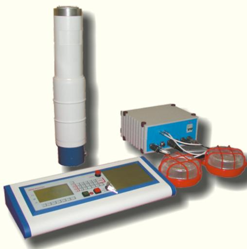
ИНТРОВОЛЬТ – это серия недорогих моноблочных аппаратов непрерывного действия с водяным охлаждением для промышленной радиографии на базе стеклянных рентгеновских трубок “Светлана-Рентген”. Могут использоваться для просвечивания на рентгеновскую пленку. Небольшой вес в сочетании с возможностью долговременной работы на максимальной мощности позволяют использовать их для мобильных применений.
