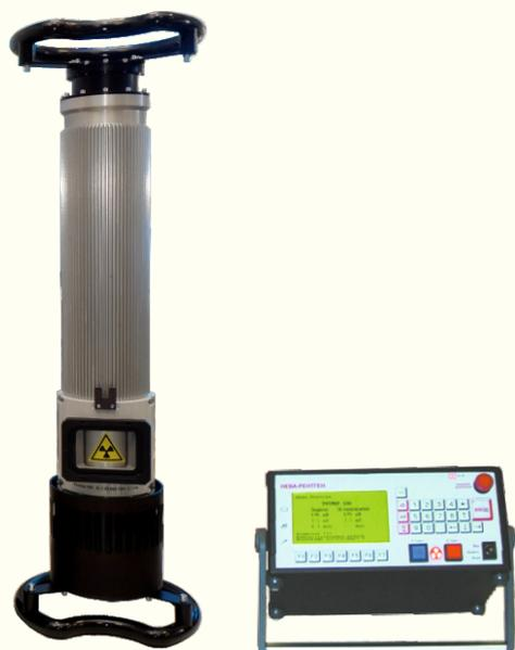
РАТМИР – это серия недорогих легких переносных аппаратов непрерывного действия со стеклянной рентгеновской трубкой. Преобразователь напряжения работает на высокой частоте, что обеспечивает высокий КПД и большую глубину просвечивания.
